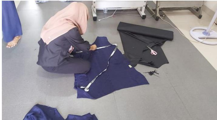
**Gambar 3. Proses Pemotongan Kain di Lantai**
